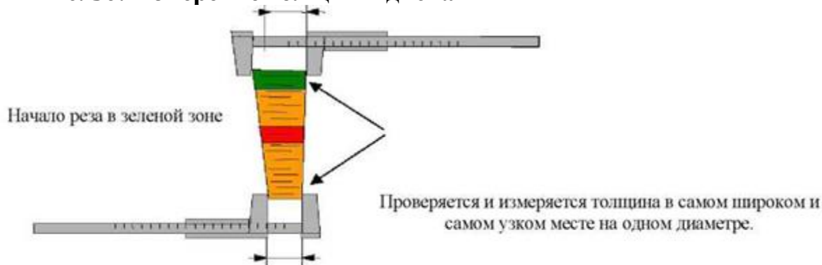
Рис. 30: Измерение толщины диска
